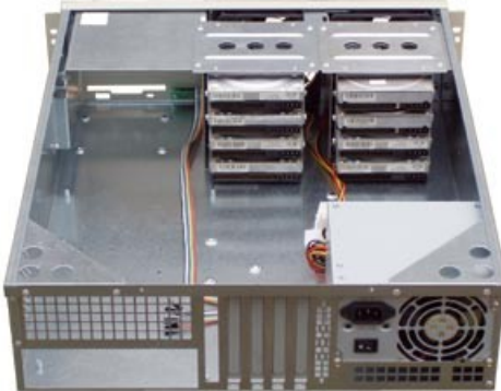
Фото 2. Вісім HDD в корпусі з додатковою корзиною 4HD34M
