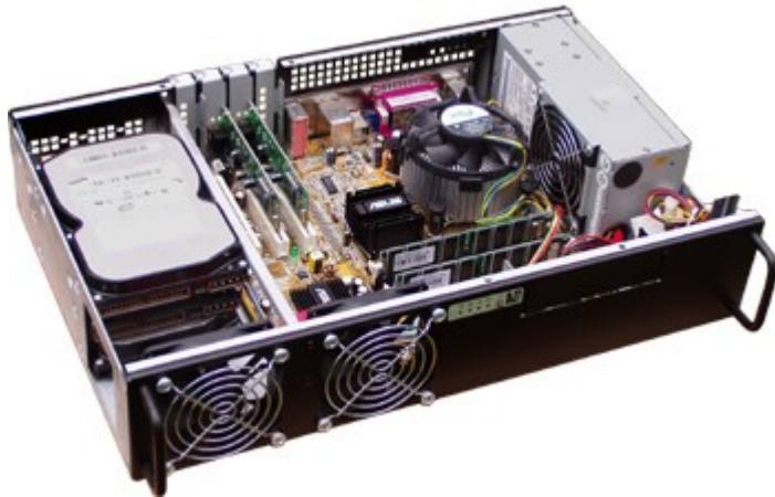
Фото 1. Корпус з установленими материнською платою, двома платами розширення Low Profile PCI, трьома HDD
