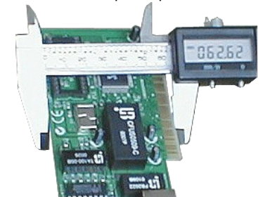
Фото 3. Вимірювання висоти плати розширення
