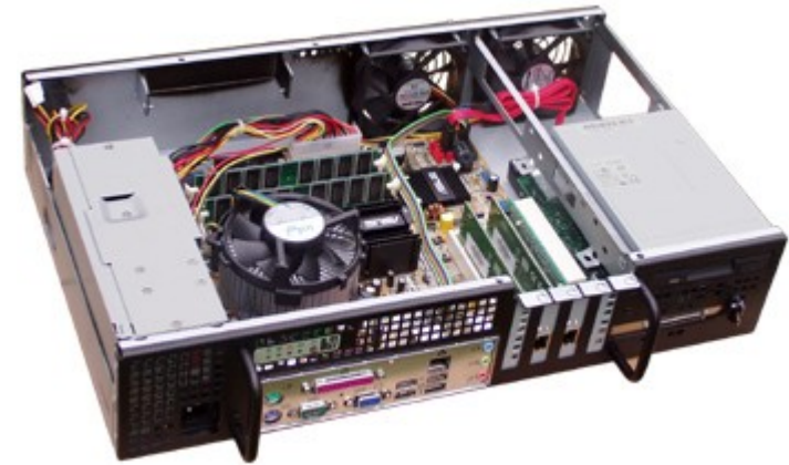
Фото 2. Корпус зі зворотним розміщенням в стійці, материнською платою, двома платами Low Profile PCI та повноформатною платою на райзері, FDD та HDD
